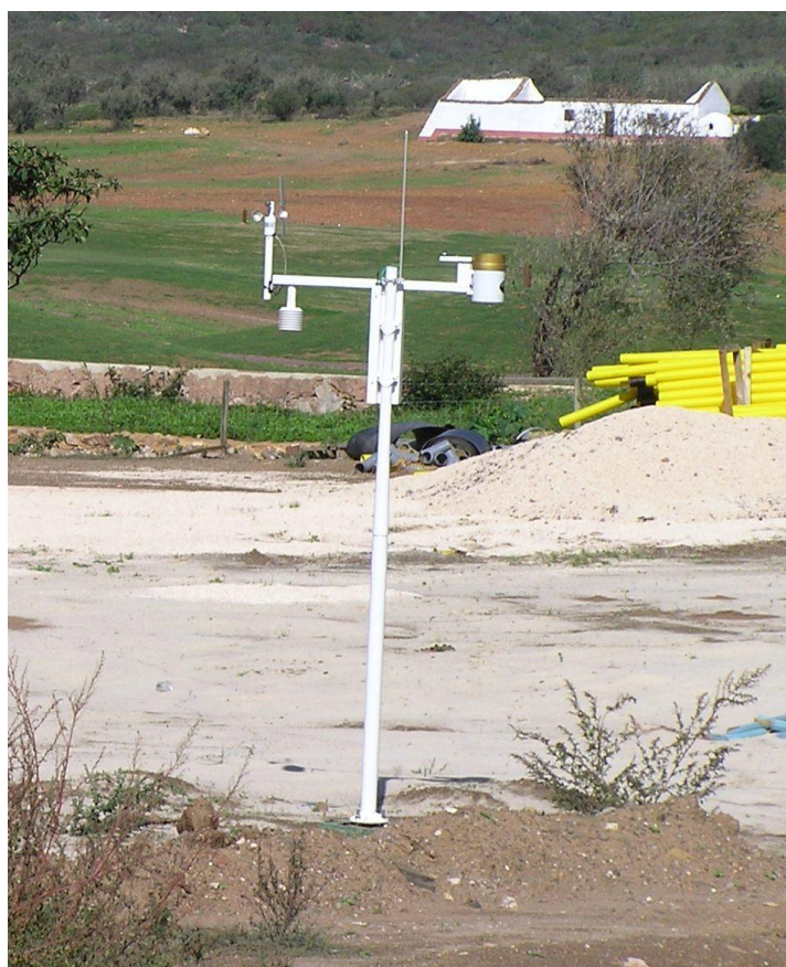
En værstasjon måler vind, temperatur og innstråling og beregner hvor mye som fordamper. Det kan være et godt hjelpemiddel. Foto: Agnar Kvalbein
